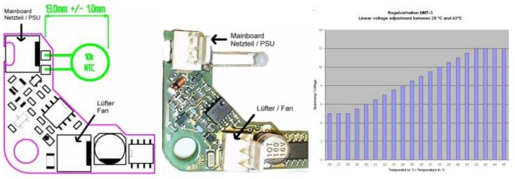
Montage der NMT-3 Thermorgelung an einen Lüfter / Mounting the NMT-3
